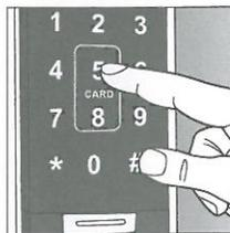
輸入原密碼 6 位數後再按 \*\*，聽到“密碼已刪除”語音，表示該密碼已刪除完成，同時藍光熄滅。
