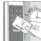
卡片不離開感應區持續感應約 5 秒後，先聽到語音“門已上鎖”；然後再嗶一長聲，藍色燈號亮起，表示防盜功能已設定連線完成。
