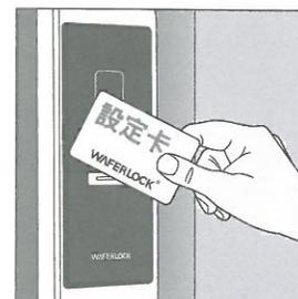
再用設定卡第三次感應門鎖，會再聽到“設定模式中”語音，並持續放在感應區約 5 秒後，聽到“刪除模式中”。設定卡移開感應區，再感應一次會聽到“子卡已全刪除”語音，同時紅色燈號閃爍 5 次，表示子卡已全部刪除。
